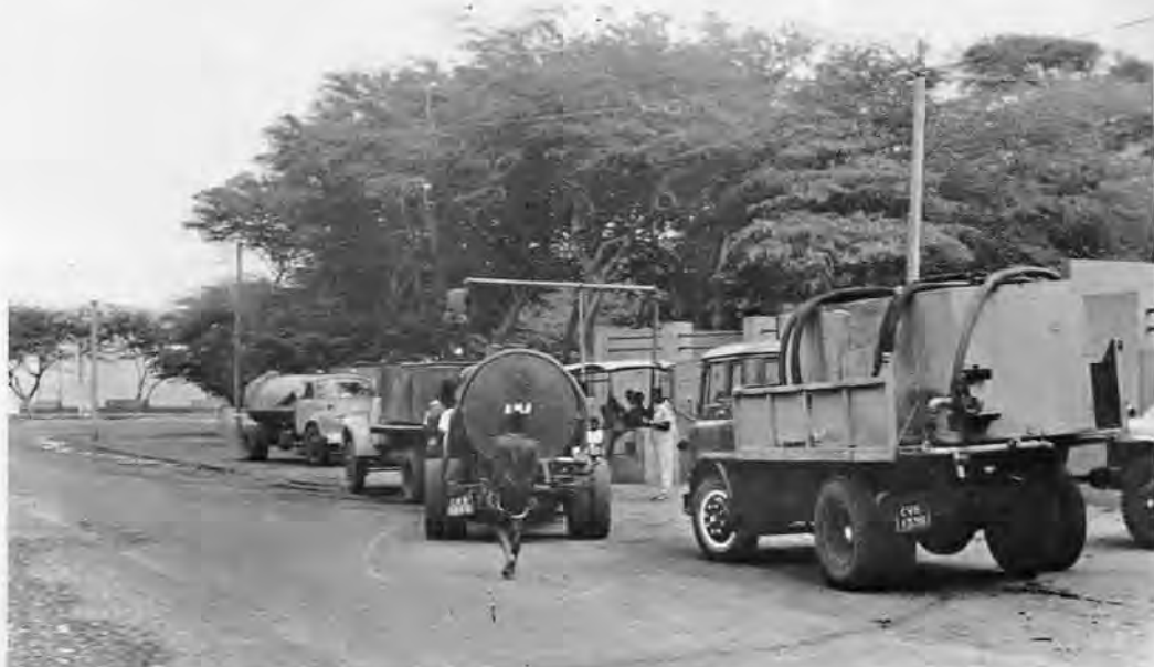
Fig. 142 — Auto-tanque de abastecimento de água
